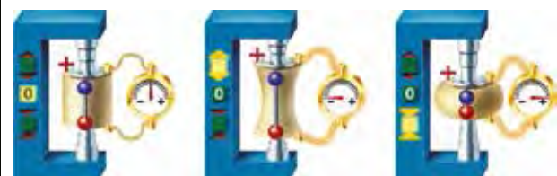
Este proceso es denominado el piezoeffecto directo. A la inversa, estos cristales también sufren una deformación controlada al ser expuestos a un campo eléctrico, un comportamiento denominado piezoeffecto inverso. La polaridad de la carga depende de la orientación del cristal relativa a la dirección de la presión.
