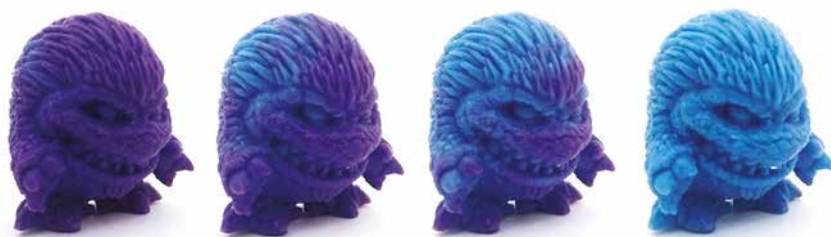
Ejemplos de objetos con sistemas cromogénicos que cambian de color a medida que aumenta o disminuye la temperatura de forma reversible.
